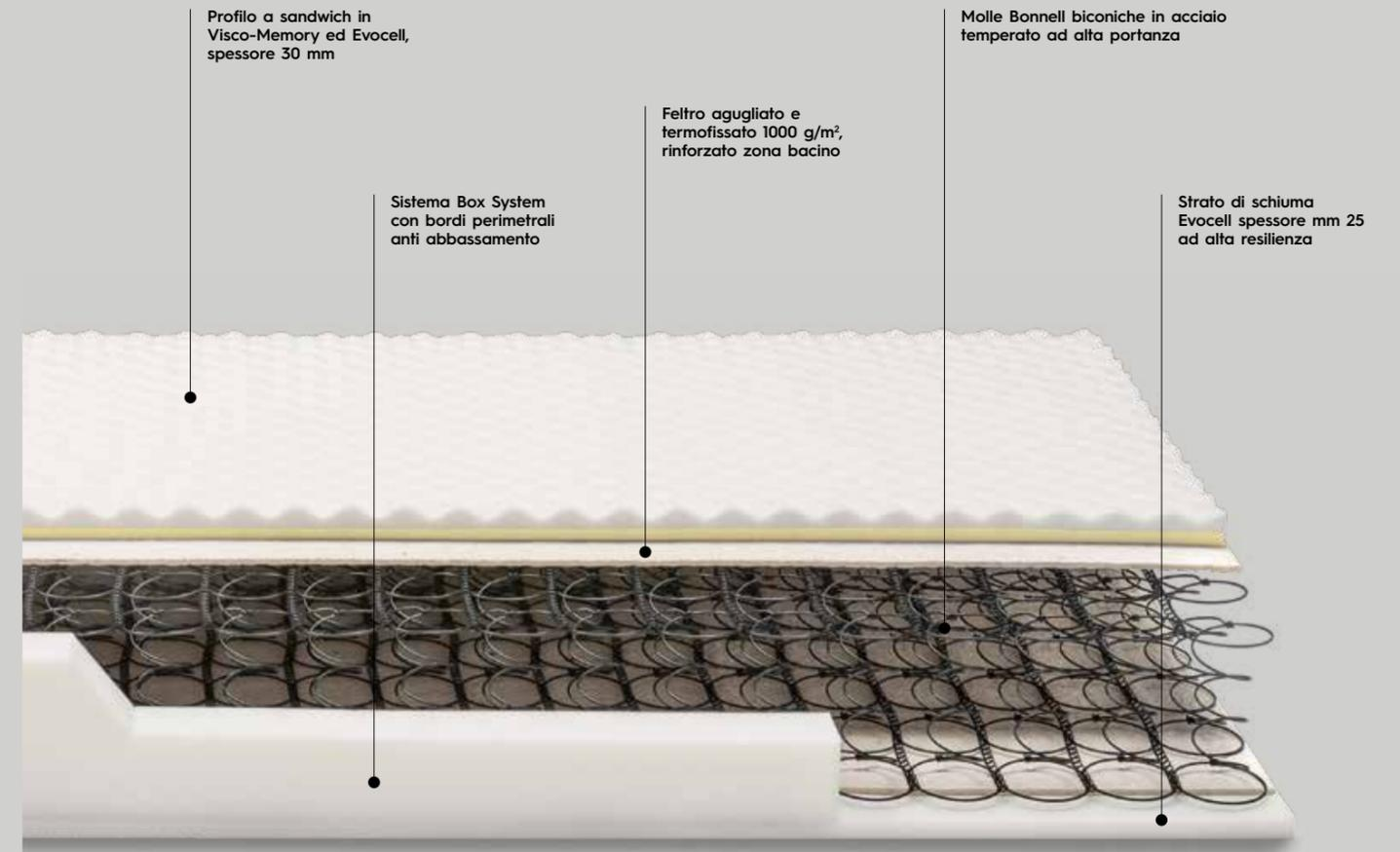
Una soluzione di sostegno che vede interagire il solido e collaudato molleggio a 400 molle biconiche Bonnell con un profilo ergonomico a sandwich dove il lato di contatto è in memory. Quest'ultimo, mettendo a frutto le proprie doti automodellanti, riesce a distribuire il peso minimizzando i punti di pressione. Il corpo è sostenuto e assecondato in ogni suo movimento, la sensazione di accoglimento è piacevole, il rilassamento dell'apparato muscolare è agevolato, per un sonno davvero rigenerante.
